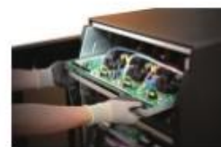
Arquitectura interna en bloques para fácil e rápido mantenimiento
